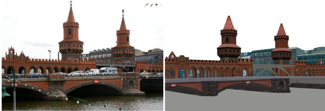
图54. 柏林的“Oberbaumbrücke”桥在LOD4中被表示为桥梁模型（左照片，右为3D CityML模型）
