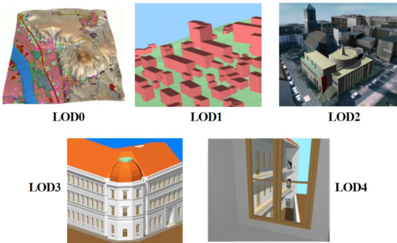
图 3. CityGML 定义的 5 个 LOD 等级 (来源于 IGG Uni BOom)
