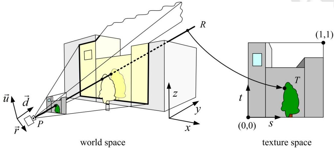
图 19. 投影式纹理映射。从投影中心 $P$ 发出的射线 $R$ 上的所有点都被映射到纹理空间中的同一个点 $T$ 上（图片：Hasso-Plattner-Institute, IGG TU Berlin）。
