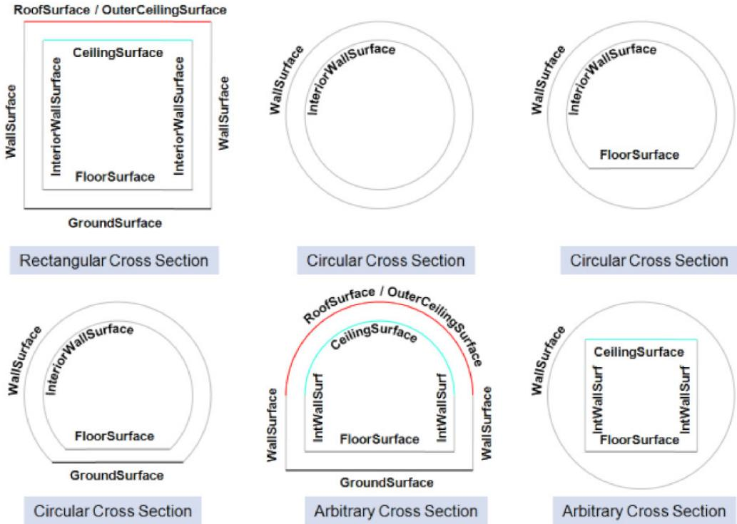
图 41. 不同横截面隧道的边界表面使用示例。墙表面，屋顶表面，地表面，外墙面和外地板表面在LOD2-4中可用，而内墙面，地板表面和天花板表面仅可在LOD4中用于建模空心墙的内部边界表面
