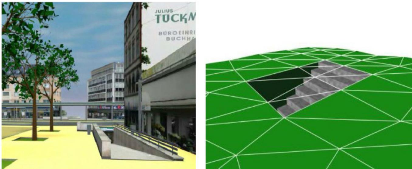
图 4. 闭合曲面封闭开放结构。通道是地下物体(左)。入口被虚拟闭合曲面封闭，它既是DTM的一部分，也是地下物体的一部分(右)(图:IGG Uni Bonn)。
