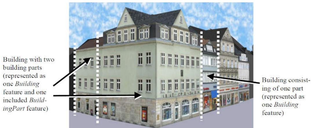
图 28. 由一个建筑（右）和两个建筑部件（左）组成的建筑示例（来源：科堡市）。
