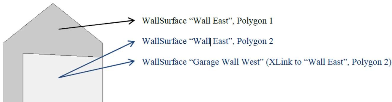
图 79. 车库与建筑物相接的边界平面。对于建筑物，该共用墙面的几何平面被拆分为非共享部分和共享部分（参见 *bldg:WallSurface* 和 *gml:name* “Wall East”）。车库通过其相应的 XLink 机制来表达和建筑物东侧墙体接触的部分。
