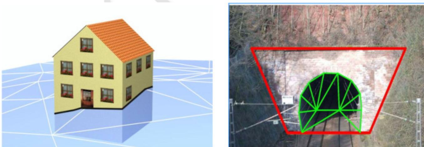
图 5. 建筑物 (左边, 黑色) 和隧道物体 (右边, 白色) 的地形交叉曲线。隧道的中空空间被一个三角形的ClosureSurface密封 (图形: IGG Uni Bonn) 。
