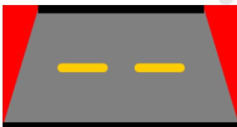
图 92. 拐弯处路段的无失真贴图纹理。红色区域在模型中不会被显示，属于浪费的纹理。
