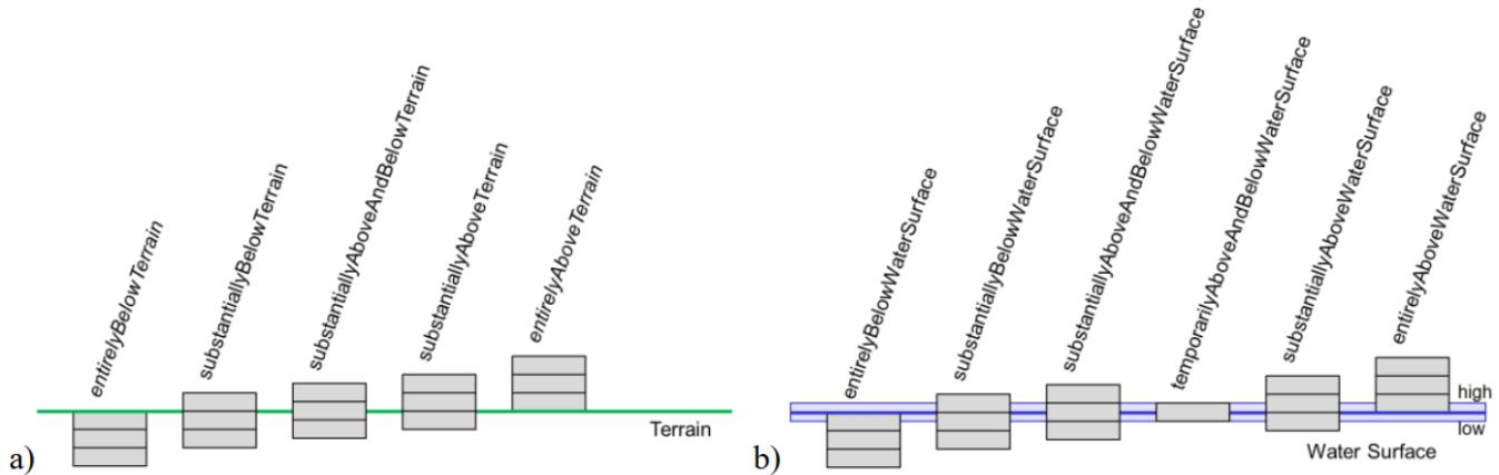
图 22. CityGML对象相对于 a) 地形和 b) 水面的拓扑关系。
