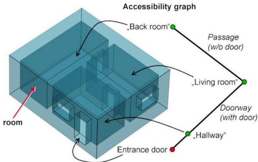
图 33. 从房间表面的拓扑邻接导出的可达性图 (图: IGG Uni Bonn)。
