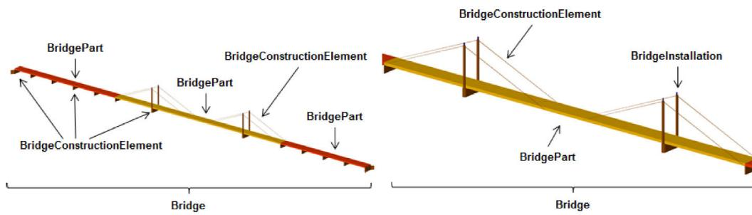
图51. Rees桥梁，由一个桥梁特征和三个桥梁部件特征（左）组成。桥包含*BridgeConstructionElement* 和*BridgeFurniture*功能（右）。
