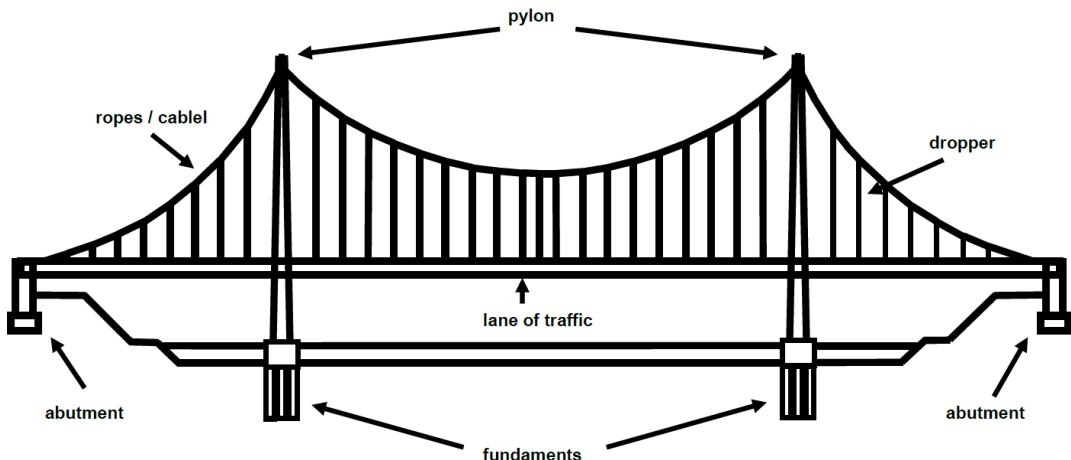
图 49. 桥梁结构悬索桥的构件。
