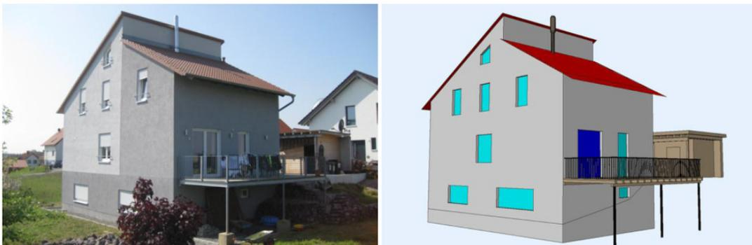
图 36. 在LOD3中建模的建筑示例。烟囱，阳台和汽车港口被建模为建筑安装（来源：KIT，由弗兰兹·约瑟夫·凯瑟提供）。
